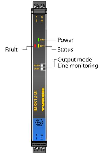
符合EN 60947-5-6 (NAMUR)标准的传感器或无电势触点可连接到IMXK12-DI01-1S-1R-0/24VDC单通道隔离开关放大器。该设备配有本安输入回路，可安装在2区。输出回路配有一个切换继电器。该设备符合NE21的要求。
