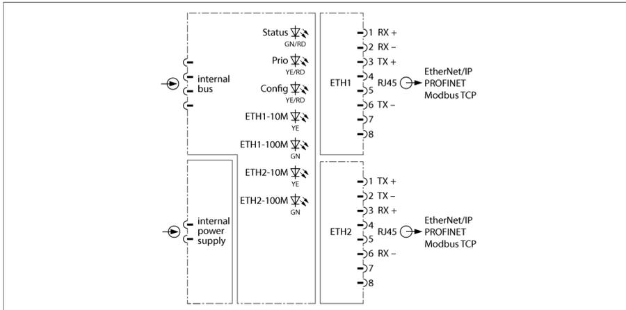
该网关用于通过Modbus TCP、Ethernet/IP和PROFINET协议将excom系统连接到更高级别的以太网现场总线。通过标准RJ45公头连接器连接到现场总线，采用质量至少为CAT5e的电缆。DLR或MRP给出的环型拓扑可以使用内置交换机实现。
