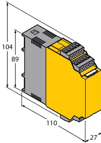
极限值监控器；信号通道；输入0/4...20mA或0/2...10V；可为2线或3线变送器/传感器供电；通过示教按钮设定极限值；三个继电器输出，每个继电器带一个常开触点；可插拔接线端子；27mm宽度；通用电源供电20...250VUC；极限值监控器的更多详细描述请见我们的“隔离栅”产品目录。
