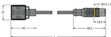
延长线缆, M12公头接插件上的A型阀式接插件, 直式, 5针, 线缆长度: 0.6 m, 护套材质: PUR材质, 黑色; 可供应其他长度和型号的线缆, 详情请登录 [www.turck.com](http://www.turck.com)
