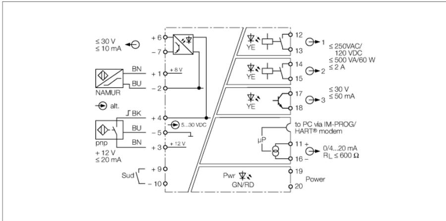
转速监控器IM21-14-CDTRI根据已调整的超速和欠速极限值分析旋转电机、齿轮或涡轮部件的频率、转速和脉冲列。当前值在设备前面的显示屏上指示。
