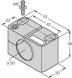
Befestigungsschelle für Gewinderohrsensoren, mit Festanschlag; Werkstoff: PA6
