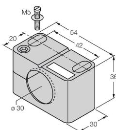
Befestigungsschelle für Gewinderohrsensoren, mit Festanschlag; Werkstoff: PA6
