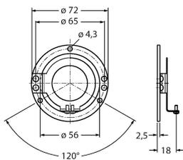
Statorkupplung aus Edelstahl für Hohlwellendrehgeber, Teilkreisdurchmesser 65 mm, für Standardapplikationen mit Axial- und Radialspiel bei hoher Dynamik
