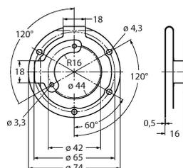
Statorkupplung aus Edelstahl für Hohlwellendrehgeber, Teilkreisdurchmesser 65 mm, für Applikationen mit Axial- und Radialspiel bei hoher Dynamik
