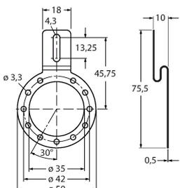
Befestigungsblech aus Edelstahl für Hohlwellendrehgeber, variabler Teilkreisdurchmesser 65...91,5 mm, für Applikationen mit Axial- und Radialspiel bei gleichbleibenden Drehbewegungen
