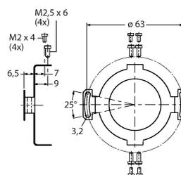
Statorkupplung aus Edelstahl für Hohlwellendrehgeber, Teilkreisdurchmesser 63 mm, für Applikationen mit hohen Genauigkeitsanforderungen
