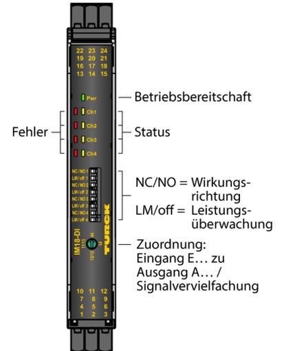
Die Trennschaltverstärker IM18-DI03-... übertragen galvanisch getrennt binäre Signale. An die Geräte können Sensoren nach EN 60947-5-6 (NAMUR) oder potenzialfreie Kontaktgeber angeschlossen werden. Die Geräte sind auch für den Betrieb in Zone 2 geeignet.
