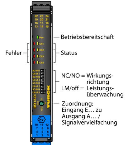
Die Trennschaltverstärker IMX18-DI03-... sind mit eigensicheren Eingangskreisen ausgestattet und übertragen binäre Signale aus dem explosionsgefährdeten Bereich in den sicheren Bereich. An die Geräte können Sensoren nach EN 60947-5-6 (NAMUR) oder potenzialfreie Kontaktgeber angeschlossen werden. Die Geräte sind auch für den Betrieb in Zone 2 geeignet.
