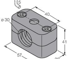
Befestigungsschelle für Glatt- und Gewinderohrsensoren; Werkstoff: Polypropylen
