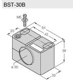
Befestigungsschelle für Gewinderohrsensoren, mit Festanschlag; Werkstoff: PA6
