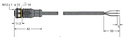
Anschlussleitung, M12-Kupplung, gerade, 3-polig, Leitungslänge: 2 m, Mantelmaterial: PVC, schwarz; cULus-Zulassung
