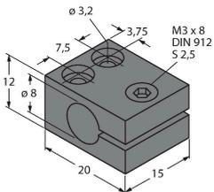
Befestigungsschelle für Gewinderohrsensoren; Werkstoff Montageblock: Aluminium, eloxiert
