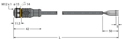
Anschlussleitung, M12-Kupplung, gerade, 4-polig, Leitungslänge: 2 m, Mantelmaterial: PVC, schwarz; cULus-Zulassung
