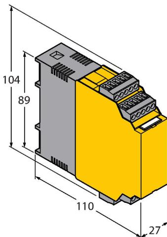
Grenzwertsignalgeber; einkanlig; Eingang 0/4...20mA oder 0/2...10V; Versorgung eines Zweidraht- oder Dreidraht- Transmitters/Sensors; Grenzwerteinstellung über Teach-Taster; Drei Relaisausgänge mit je einem Schließer; abziehbare Klemmenblöcke; 27 mm Breite; Universelle Betriebsspannung 20...250VUC; weitere Grenzwertsignalgeber im Katalog Interfacetechnik
