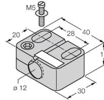
Befestigungsschelle für Gewinderohrsensoren, mit Festanschlag; Werkstoff: PA6
