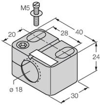
Befestigungsschelle für Gewinderohrsensoren, mit Festanschlag; Werkstoff: PA6
