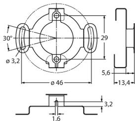
Statorkupplung aus Edelstahl für Hohlwellendrehgeber, Teilkreisdurchmesser 46 mm, für Applikationen mit Axial- und Radialspiel bei hoher Dynamik
