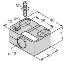
Befestigungsschelle für Gewinderohrsensoren, mit Festanschlag; Werkstoff: PA6
