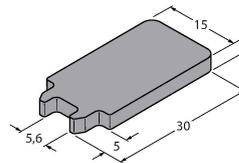
Lösewerkzeug der Montageelemente für Linearwegsensoren LI-Q17L
