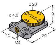
Freier Positionsgeber für Linearwegsensoren LI-QR14 und LI-Q17L; Quer- und Längsbefestigung möglich; der Nennabstand zum Sensor beträgt 1,5 mm; Kopplung mit dem Linearwegsensor bei einem Abstand von bis zu 3 mm oder einem Querversatz bis zu 3 mm
