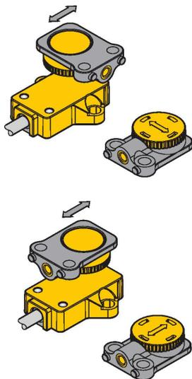
Höchste Flexibilität bei der Montage wird dadurch erzeugt, dass der Positionsgeber um 90° versetzt befestigt werden kann. Bedingt durch das Messprinzip, das auf einer Schwingkreiskopplung basiert, wird der Linearwegsensor nicht durch aufmagnetisierte Eisenteile oder sonstige Störfelder beeinflusst.
