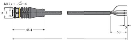
Anschlussleitung, M12-Kupplung, gerade, 4-polig, Schirm auf Überwurfmutter aufgelegt; Leitungslänge: 2 m, Mantelmaterial: PUR, schwarz; cULus-Zulassung
