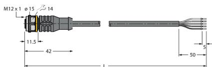
Anschlussleitung, M12-Kupplung, gerade, 5-polig, Leitungslänge: 2 m, Mantelmaterial: PVC, schwarz; cULus-Zulassung
