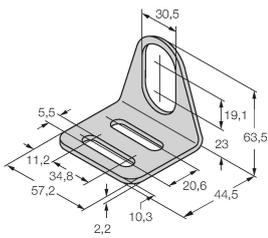
Befestigungswinkel für Gewinderohrsensoren; Werkstoff: Edelstahl A2 1.4301 (AISI 304)
