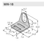
6945004 Befestigungswinkel für Gewinderohrsensoren; Werkstoff: Edelstahl A2 1.4301 (AISI 304)
