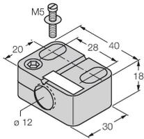
Befestigungsschelle für Gewinderohrsensoren, mit Festanschlag; Werkstoff: PA6
