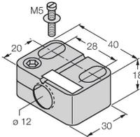
Befestigungsschelle für Gewinderohrsensoren, mit Festanschlag; Werkstoff: PA6
