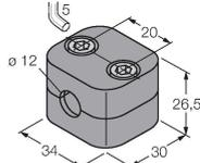
Befestigungsschelle für Glatt- und Gewinderohrsensoren; Werkstoff: Polypropylen
