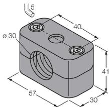
Befestigungsschelle für Glatt- und Gewinderohrsensoren; Werkstoff: Polypropylen
