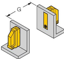
Sensoren können direkt nebeneinander montiert werden, wenn ein Sensor mit versetzter Oszillatorfrequenz Bi5U-Q12.../F2 verwendet wird.
