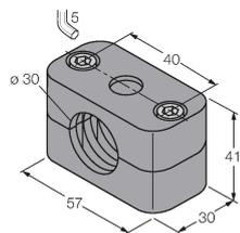
Befestigungsschelle für Glatt- und Gewinderohrsensoren; Werkstoff: Polypropylen
