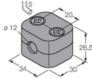
Befestigungsschelle für Glatt- und Gewinderohrsensoren; Werkstoff: Polypropylen
