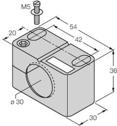
Befestigungsschelle für Gewinderohrsensoren, mit Festanschlag; Werkstoff: PA6
