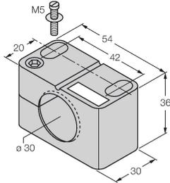
Befestigungsschelle für Gewinderohrsensoren, mit Festanschlag; Werkstoff: PA6
