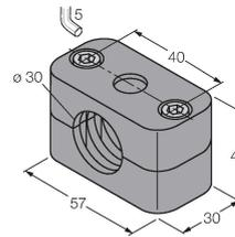
Befestigungsschelle für Glatt- und Gewinderohrsensoren; Werkstoff: Polypropylen
