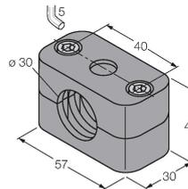
Befestigungsschelle für Glatt- und Gewinderohrsensoren; Werkstoff: Polypropylen
