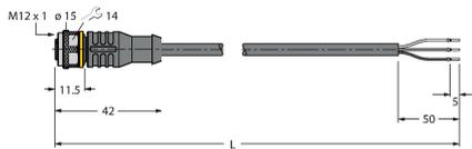
Anschlussleitung, M12-Kupplung, gerade, 3-polig, Leitungslänge: 2 m, Mantelmaterial: PVC, schwarz; cULus-Zulassung
