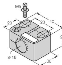
Befestigungsschelle für Gewinderohrsensoren, mit Festanschlag; Werkstoff: PA6
