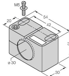
Befestigungsschelle für Gewinderohrsensoren, mit Festanschlag; Werkstoff: PA6
