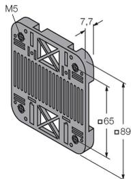
Montageplatte für DIN-Hutschiene, geeignet für Bauform CP80, DX80, K80, Q80, Betriebstemperatur: -20...+90 °C
