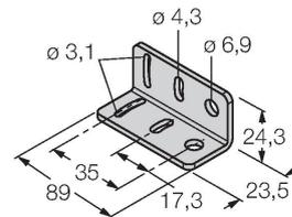
Montagewinkel, Edelstahl, für Bauform MINI-BEAM NAMUR
