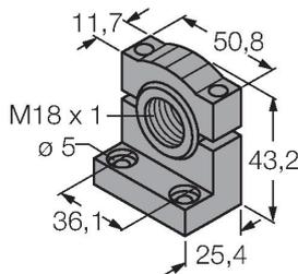
Montagehalterung, PBT-schwarz, für Sensoren mit 18-mm-Gewinde, ausrichtbar
