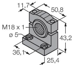
Montagehalterung, PBT-schwarz, für Sensoren mit 18-mm-Gewinde, ausrichtbar
