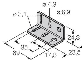
Montagewinkel, Edelstahl, für Bauform MINI-BEAM NAMUR
