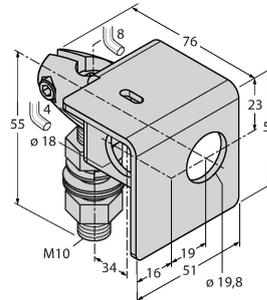
Montagewinkel, Werkstoff VA 1.4401, für 18mm-Gewinde, Gewinde M10 x 1,5
