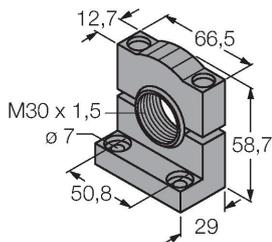
Montagehalterung, PBT-schwarz, für Sensoren mit 30-mm-Gewinde, ausrichtbar
