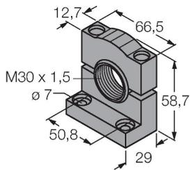
Montagehalterung, PBT-schwarz, für Sensoren mit 30-mm-Gewinde, ausrichtbar
