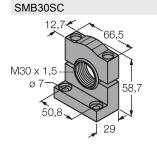
3052521  $Montage halterung, \, PBT\text{-}schwarz, \,$ für Sensoren mit 30-mm-Gewinde, ausrichtbar
