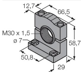
Montagehalterung, PBT-schwarz, für Sensoren mit 30-mm-Gewinde, ausrichtbar
