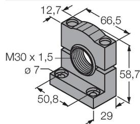
Montagehalterung, PBT-schwarz, für Sensoren mit 30-mm-Gewinde, ausrichtbar
