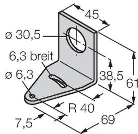
Montagewinkel, rechtwinklig, Edelstahl, für Sensoren mit 30mm Gewinde
