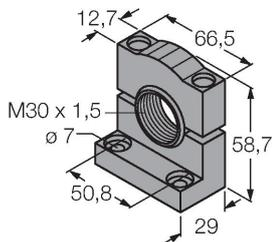
Montagehalterung, PBT-schwarz, für Sensoren mit 30-mm-Gewinde, ausrichtbar
