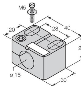
Befestigungsschelle für Gewinderohrsensoren, ohne Festanschlag; Werkstoff: PA6
