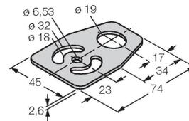
Montageplatte, Edelstahl, für Sensoren mit 18mm Gewinde
