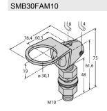
3011185 Montagewinkel, Edelstahl, für 30mm-Gewinde, Gewinde M10 x 1,5
