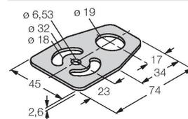
Montageplatte, Edelstahl, für Sensoren mit 18mm Gewinde
